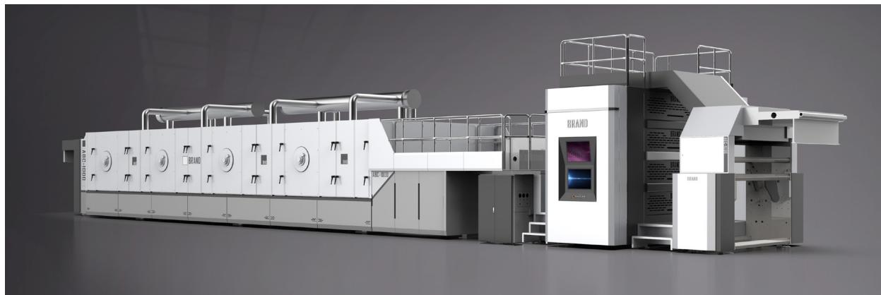
高斯中国联合长胜科技公司围绕印染设备绿色转型升级开展合作，在柔性版印刷工艺的基础上进行印染创新，提出将印刷与印染结合起来的冷转移新工艺，实现“以印代染”，有效减少传统染布工序的能耗和污水排放等环境污染问题。
