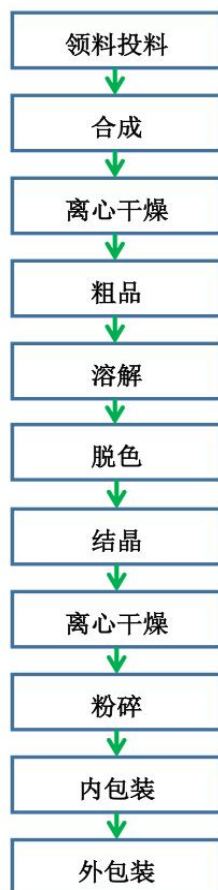
综合原料药生产工艺流程图
