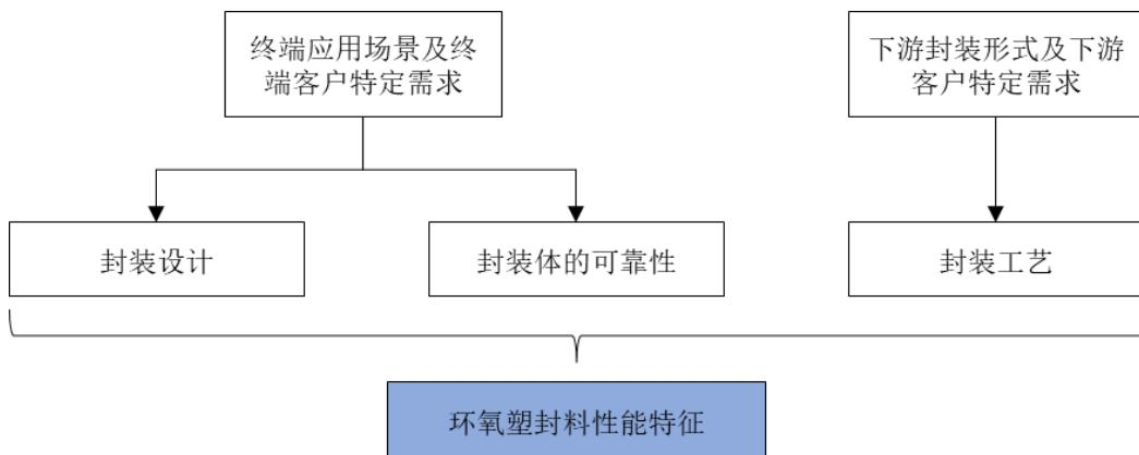
根据上市公司作为第一起草单位主持制定的《电子封装用环氧塑封料测试方法》（GB/T 40564-2021）国家标准，衡量环氧塑封料产品的主要性能指标包括 CTE、Tg、弯曲强度、弯曲模量以及吸水率等，各项指标具体含义解释如下：
